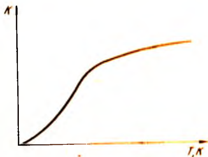
XVII. 4-расм. Ҳароратларнинг кен соҳасида реакция тезлик константасининг ҳароратга боғлиқлиги (Аррениус бўйича).
