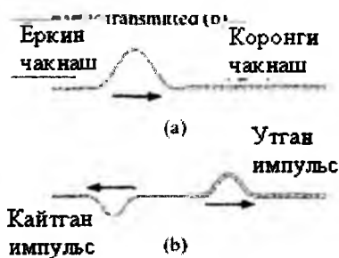
8-15-rasm. To'liqin impulsi arqon bo'ylab o'ng tomonga siljiganda arqon qalinroq va og'irroq bo'lib qoladi va (a) to'liqinning bir qismi qaytadi, (b) bir qismi o'tadi.
