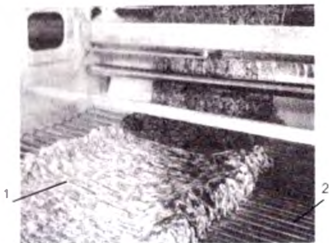
47- rasm. Kamera konveyeri roliklari ustidagi mato taxlami: 1 – mato yoki trikotaj polotnosi taxlami; 2 – konveyer roligi.
