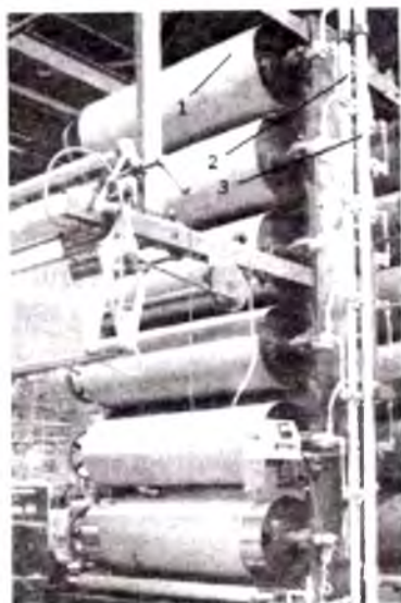
168- rasm. Quritish barabanlarining bug' berish va kondensat chiqarish tarafidan ko'rinishi.
