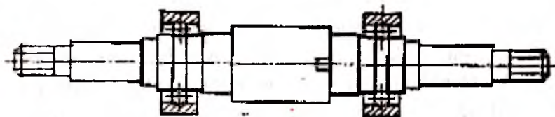
5.14-rasm. Tezkor tayanchlarda ichki halqani val sirti bilan almashtirish.
