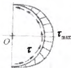
6.12-rasm. Yarim halqasimon kesimda urinma kuchlanishlar oqimi va tarqalish qomuniyati.
