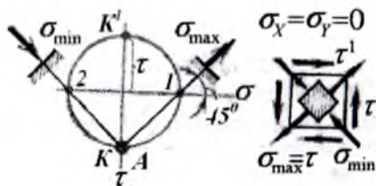
4.2-rasm. Sof siljishda bosh kuchlanishlarni aniqlash uchun Mor doirasi.
