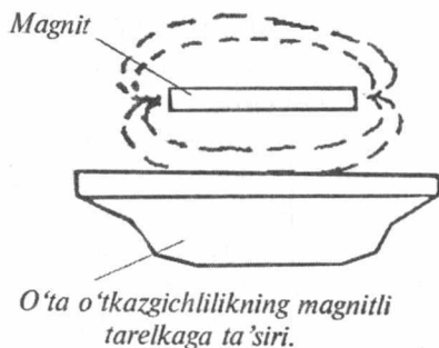
11.11-rasm. O'ta o'tkazgichlikning magnitli tarelkaga ta'siri.
