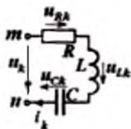
3.2-rasm. r, L, C elementlarni ketma-ket ulanishi.
