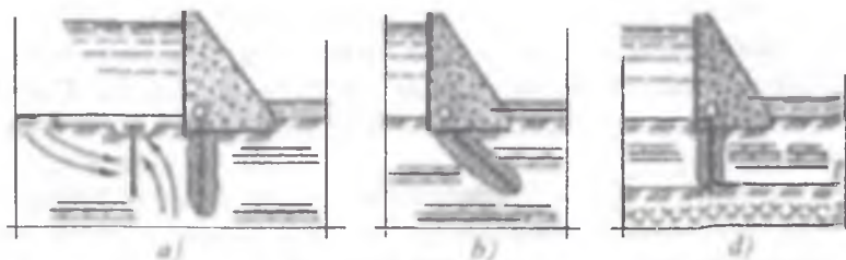
3.32-rasm. Kimyoviy suffoziyani bartaraf etish tadbirlari sxemalari: a – ponur va drenaj inshoot oldida; b – yotiq sementli to'siq parda; d – erimaydigan jinslargacha yetkazilgan sementli to'siq parda.
