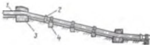
5.51-rasm. Qirgilgan po'lat quvur: 1—quvur; 2 kompensator; 3,4—akkerli va oraliqdagi tayanchlar.
