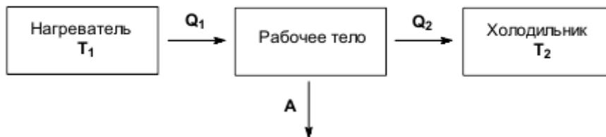
Рис. 1.1 Схема тепловой машины
