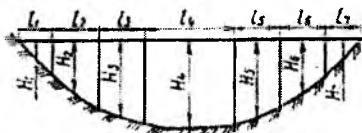
6.33-rasm. To'g'on tanasi orqali o'tadigan umumiy filtratsiya sarfini aniqlash hisobiy sxemasi.
