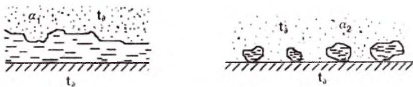
10.3- rasm. Kondensatsiyalanishda issiqlik berilish sxemasi.
