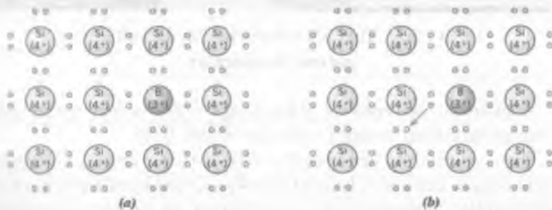
10.13-rasm. P turidagi aralashmali yarimo'tkazgichlar uchun elektron aloqalar modeli: a – borning uch valentli atomi kabi begona atom kremniy atomini almashtiradi 23 .
