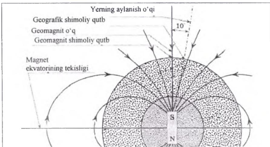
**5.2 - rasm.** *Geomagnit maydon, magnit kuch chiziqlari strelka bilan ko'rsatilgan*
