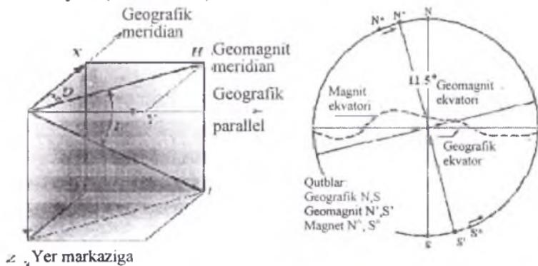
**5.3-rasm.** *Geomagnit maydon elementlari: X, Y, Z – komponentlar, T – to'liq vektor, D – magnit og'ish burchagi, I – magnit qiyaligi*
