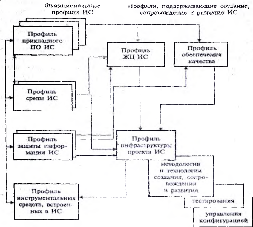
Рис. 3.1. Взаимосвязи функциональных профилей ИС и профилей, поддерживающих создание, сопровождение и развитие ИС.
