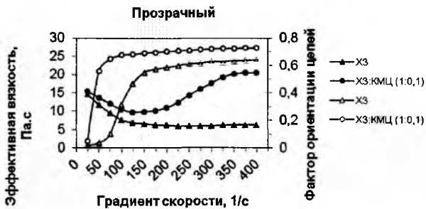
Рис. 7.2. Зависимость вязкости и фактора ориентации от градиента скорости продольного поля для растворов хитозана и его смесей с КМЦ (1:0,1).
