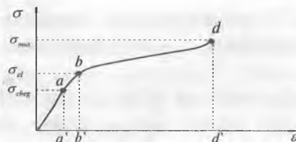
2-rasm. Ba'zi bir metallar uchun kuchlanishning nisbiy uzayishga bog'liqlik grafigi.
