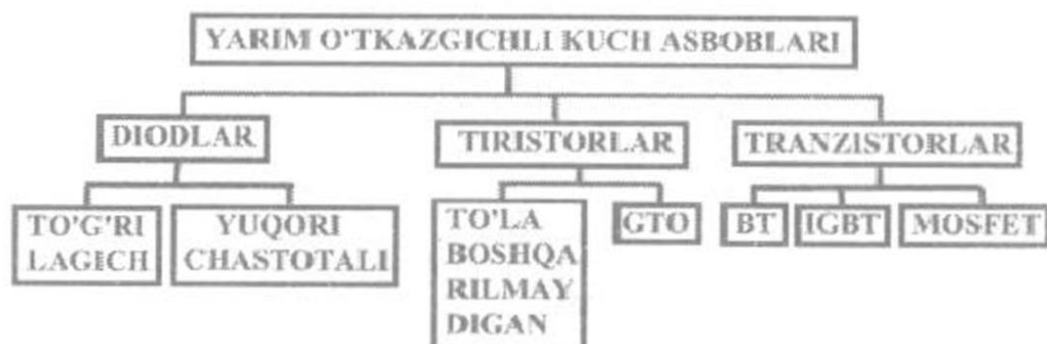
2.1-rasm. Yarim o'tkazgichli kuch elementlarining sinflanishi
