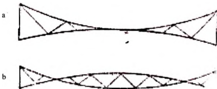
28.4-rasm. Ikki belbog'li trosli sistemalar (trosli fermalar): a–kesishmaydigan belbog'lar bilan; b–kesishuvchi belbog'lar bilan
