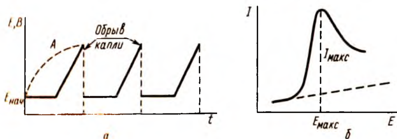
Рис. 10.38. Пилообразная развертка поляризующего напряжения ( E = E_{\text{нач}} - \nu t ) (а) и осциллограмма (б)
