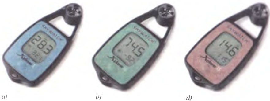
53-rasm. Choʻntak anemometrlari: a – «Xplorer-1»; b – «Xplorer-2»; d – «Xplorer-3».
