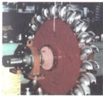
44-rasm. Osilgan (a) va yotqizilgan (b) cho'michli ish g'ildiraklari.
