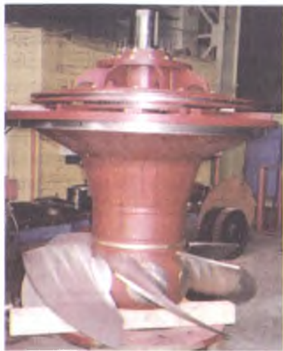
36-rasm. Parrakli turbina rotorining yig'ilgan holatdagi ko'rinishi.
