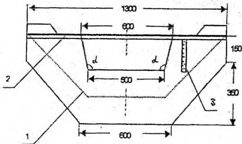
Рис. 5. Трапецидальный водослив Чиполетти (ВЧ-50):
