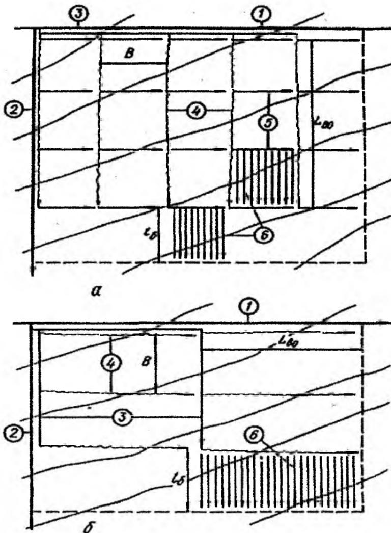
**Рис. 1. Схемы расположения временной оросительной сети на орошаемой карте:**
