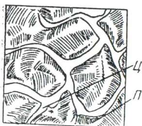
9-rasm. Pulatlarning ichki tuzilishi
