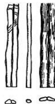
7-rasm. Tabiiy ipakning tashqi ko'rinishi va ko'ndalang kesim yuzasi.
