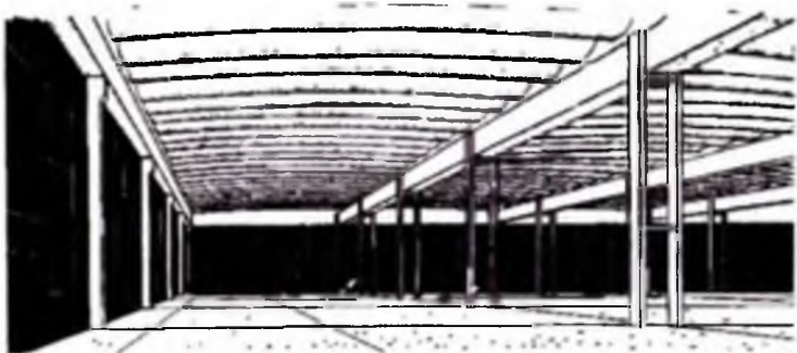
6.4-rasm. Yirik ustunlar to'ri bilan tiklanadigan bir qavatli universal sanoat binosining interyeri.
