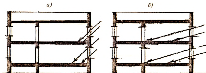
Рис. 3.4. Характер поступления солнечных лучей при ориентации классов по сторонам света: а — юго-зап., юг, юго-вос., б — зап., вос.
