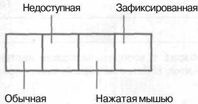
**Рис. 4.11.** Структура битового образа Glyph: картинки, соответствующие состоянию кнопки
