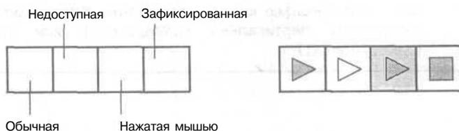
**Рис. П1.15.** Структура и пример битового образа Glyph: картинки, соответствующие состоянию кнопки
