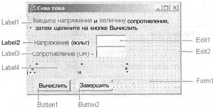
**Рис. 2.17.** Окончательный вид формы программы "Сила тока"
