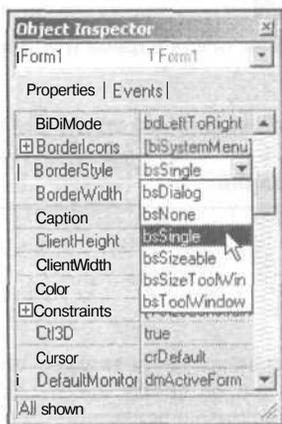
Рис. 2.3. Установка значения свойства путем выбора из списка
