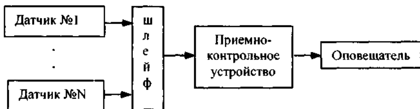
Рис. 4. Структура типовой системы охранной сигнализации
