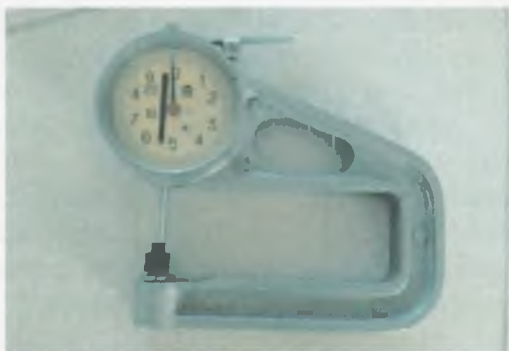
Рис.2.1. Прибор для определения толщины тканей
