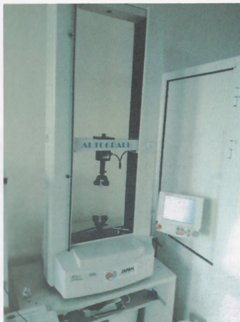
Рис. 2.4. Прибор AUTOGRAPHAG – 1 для определения разрывной нагрузки и разрывного удлинения тканей
