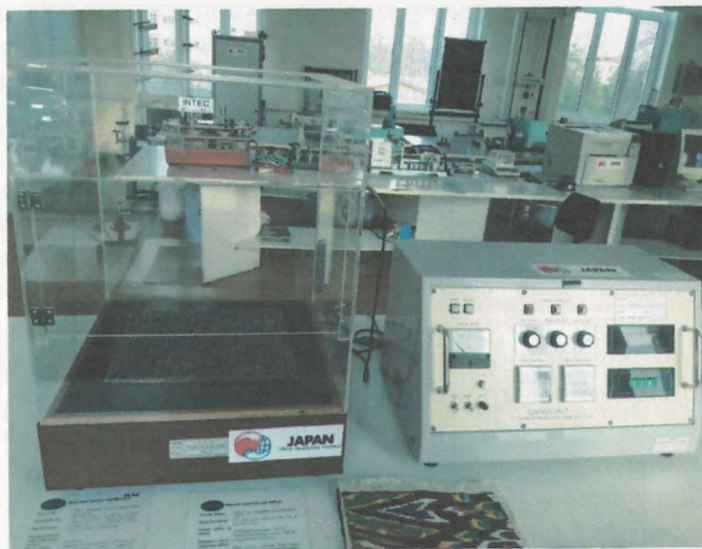
Рис.2.8. Прибор AW-2 для определения теплопроводности тканей
