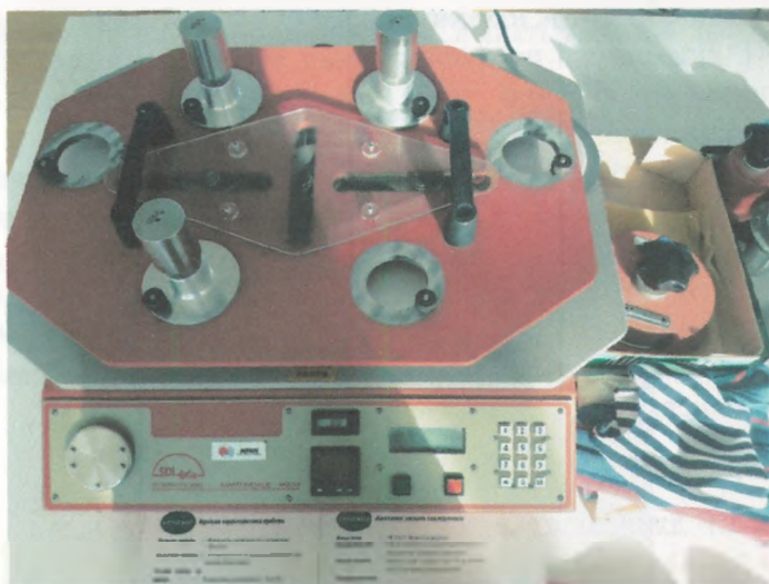
Рис.2.6. Прибор М-235 для определения стойкости к истиранию тканей
