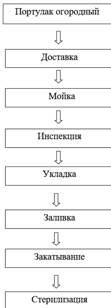
Рисунок 1. Технологическая схема консервирования портулака огородного
