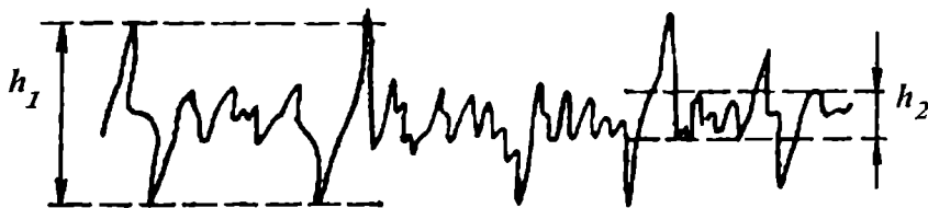
1.18-rasm. Bosma qog‘oz yuzasining mikrogeometriyasi: h_1 –makronotekisliklar; h_2 –mikronotekisliklar.
