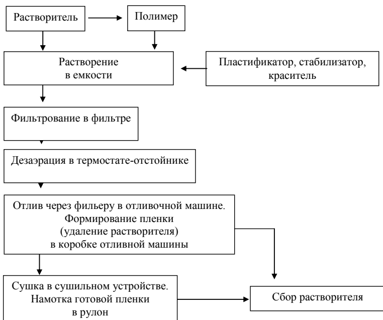
Рис. 3.4. Схема формования пленок отливом из раствора
