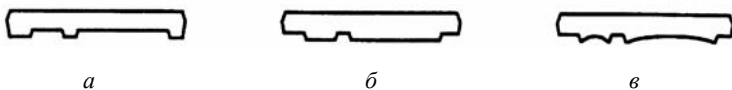
Рис. 4.4. Штампы для: а — конгревного тиснения; б — плоского (блинтового) тиснения; в — рельефного тиснения
