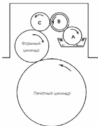
Рис. 2.1. Схема лакировального аппарата валкового типа:
