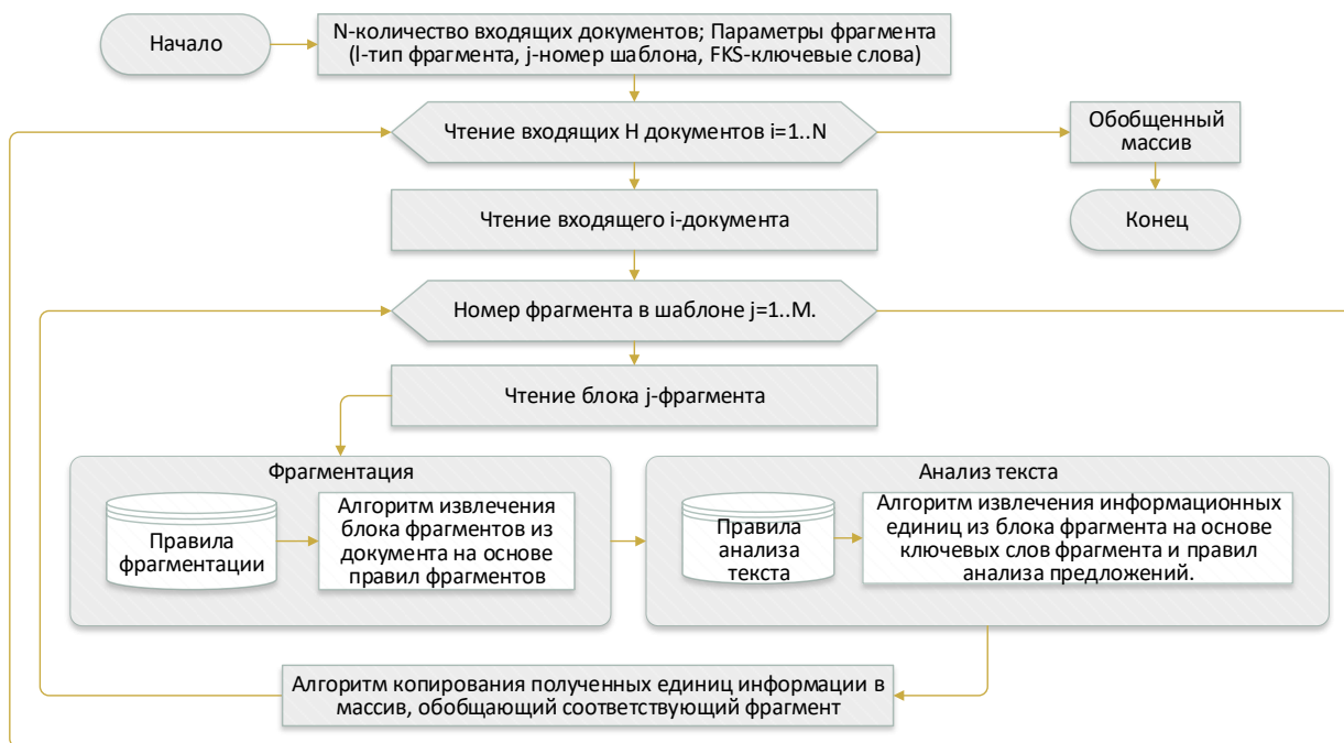
Рис. 8. Алгоритм извлечения информации из блока фрагментов документов
