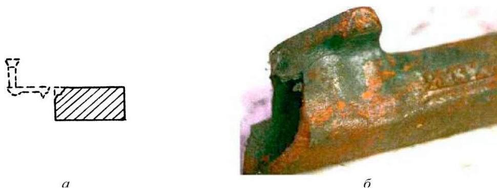
Рис. 65. Дефект - вылом: а - схема; б - дефектная отливка
