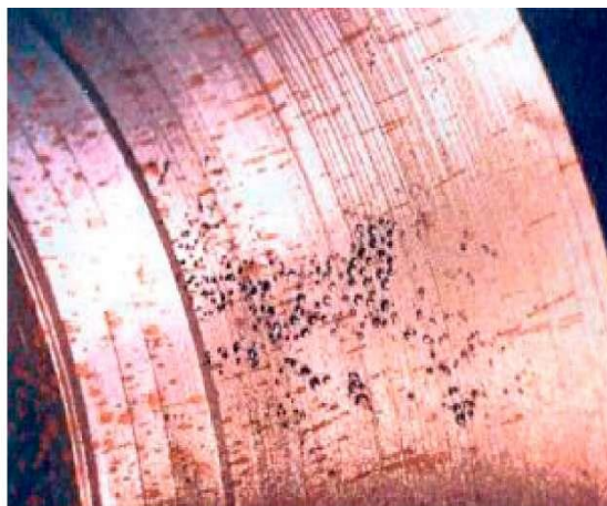
Рис. 73. Дефект - усадочная пористость: a - схема; б - дефектная отливка
