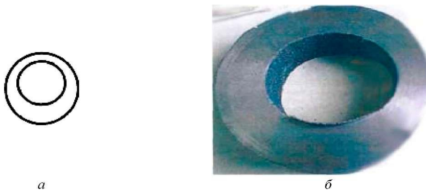
Рис. 63. Дефект - разностенность: а - схема; б - дефектная отливка
