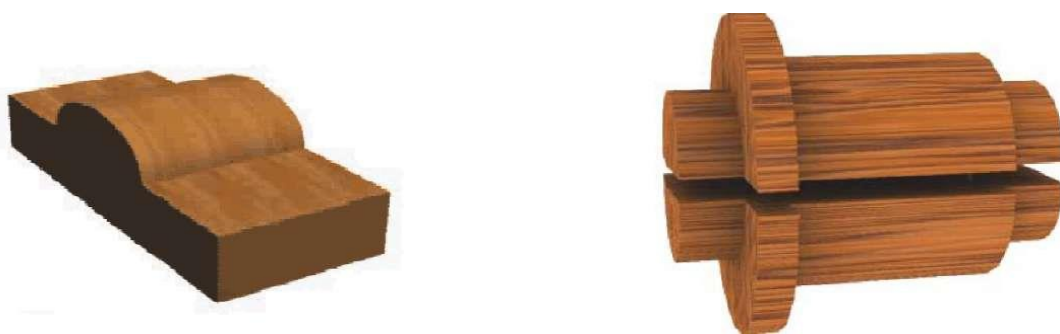
Рис. 13. Типы моделей: a - неразъемные; б – разъемные
