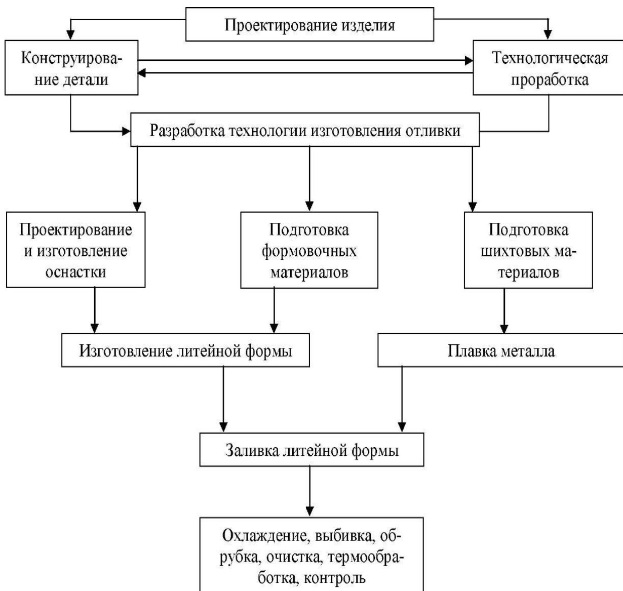
Рис.1. Схема технологического процесса получения отливки
