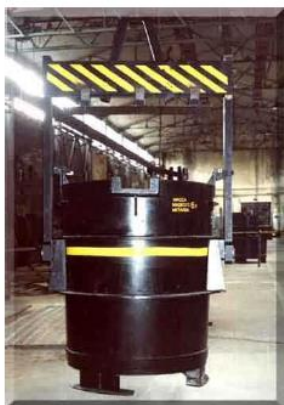
Рис. 152. Общий вид двухстопорного сталеразливочного ковша:
