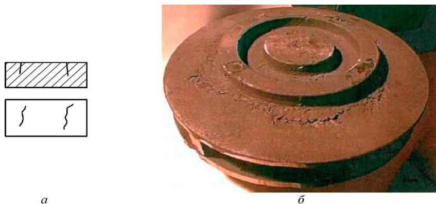
Рис. 69. Дефект - горячая трещина: a - схема; б - дефектная отливка
