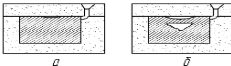
Рис. 96. Концентрированные усадочные раковины:
