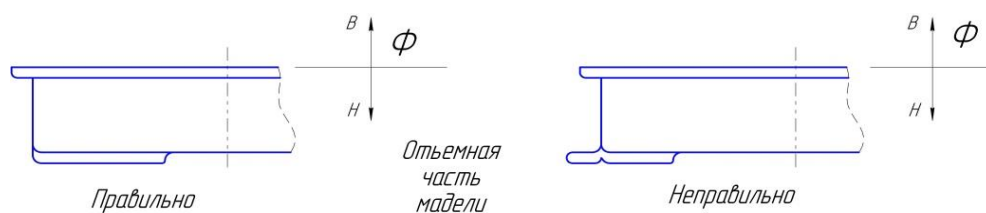
Рис. 84. Конструкция отъемных частей модели
