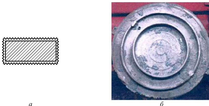
Рис. 66. Дефект - пригар: а - схема; б - дефектная отливка
