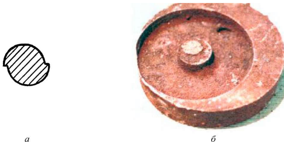
Рис. 61. Дефект - перекося: а - схема; б - дефектная отливка
