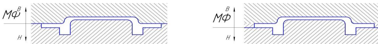
Рис. 83. Пример выбора поверхности разъема формы
