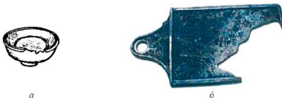
Рис.59.Недолив в результате недостаточной жидкотекучести (холодный металл): а -схема, б -дефектная отливка
