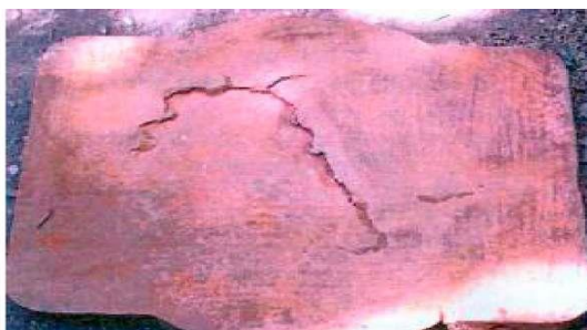
Рис. 67. Дефект - ужимина: а - схема; б - дефектная отливка
