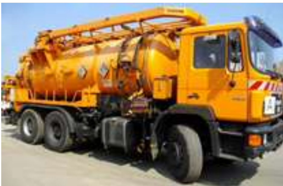
5.6-расм. MAN26.322 шассисида бажарилган канал ювиш автомашинаси.
