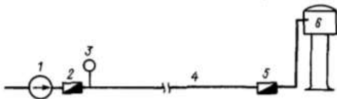
Расм.4.3. Сув ўлчагичлар орқали сизиб чиққан сув миқдорини аниқлаш тасвири
