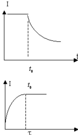
Схема включения цепи с соленоидом. Время релаксации  $\tau$  - время, необходимое для установления в рабочих цепях режима равновесной (стационарной) работы.
