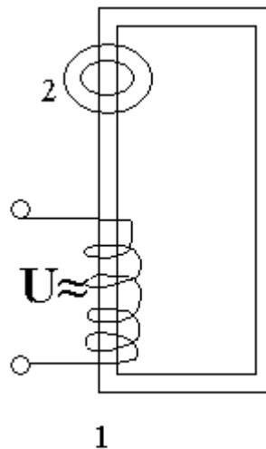
При подаче переменного напряжения (тока) на первый 1 соленоид со второго 2 можно снять переменное напряжение (ток) противоположного направления (закон Фарадея-Ленца) Так как магнитное поле замкнутое, то сердечники делаются сплошными, чтобы избежать потери магнитного поля. Тогда сам сердечник создает замкнутый контур, по которому может протекать электрический ток. Если сопротивление сердечника мало, то по закону Джоуля-Ленца количество теплоты,
