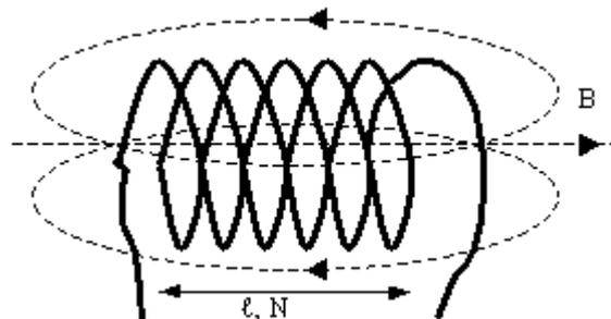
Используем соленоид для создания магнитного поля.  $r$  - радиус соленоида,  $l$  - его длина,  $N$  - число витков,  $n$  - удельное число витков соленоида. Запишем напряженность соленоида
