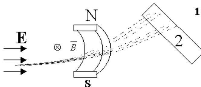
С поверхности вещества испаряют часть атомов или молекул. Как правило, при этом такие атомы обладают зарядовыми свойствами. Далее эти атомы ускоряются в электрическом поле  $E$ , и движущийся поток атомов пропускают через магнитное поле  $B$ . По закону Лоренца эти заряды в магнитном поле отклоняются. Тогда на
