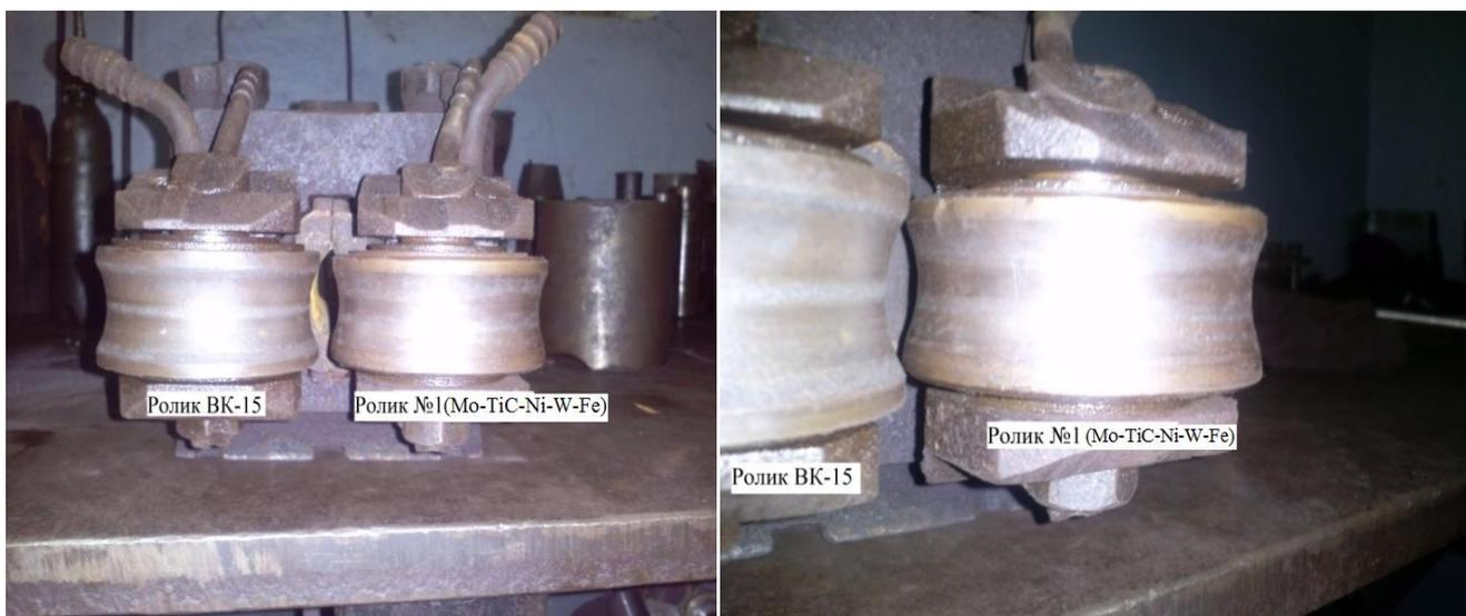
**Рис.2.9. Съёмки роликов после проката заготовок изделий весом 5547 т**
