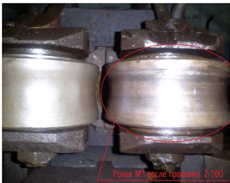
**Рис.2.8. Съёмки роликов после проката заготовок изделий весом 2200 т**
