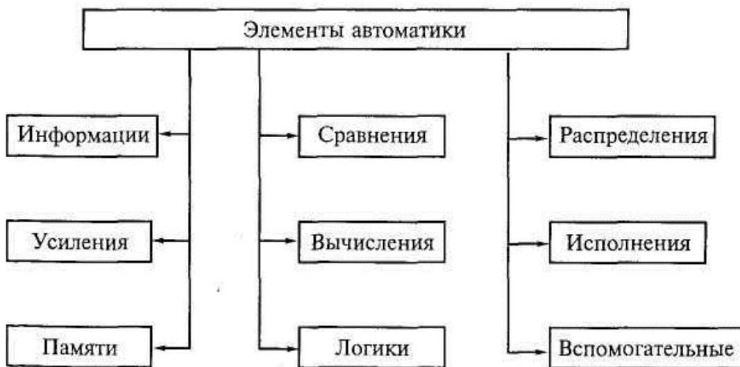
4-rasm. Funktsional belgilariga ko'ra avtomatika elementlarining klassifikatsiyasi.
