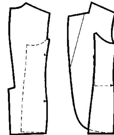
Рис. 3.4. Схема отработки продольных срезов пиджака на технологичность [15].
