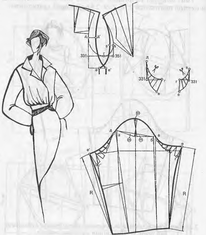
2.39-рasm. Елка ёстиқчали, елка чоки узайтирилган ва чуқурлаштрилган ўмизли буюмнинг бир чокли ўтказма енгини моделлаш схемаси.
