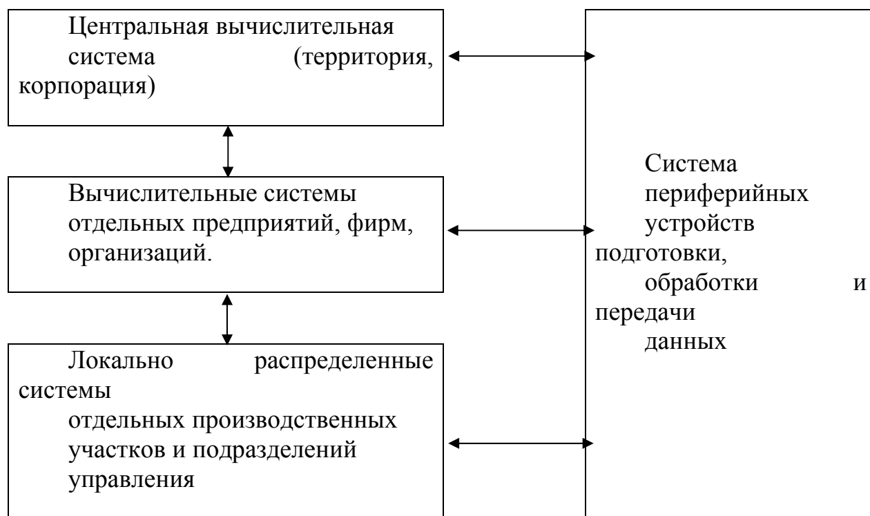
Рисунок 2 – Принципиальная схема многоуровневой организации программно-технических средств ИС
