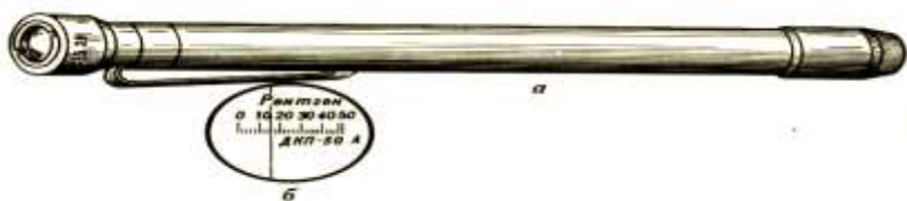
16-Расм. ДКП-50А дозиметри: а – умумий кўриниши; б – шкаласи.
